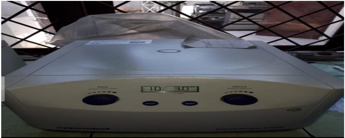
Centrifuge untuk memisahkan serum dari sel-sel darah
