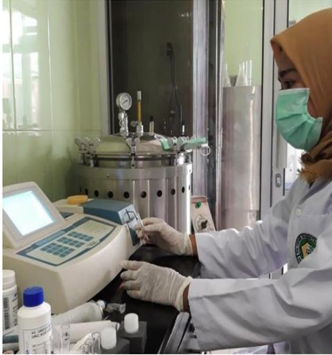
**Gambar 5. Proses pembacaan blanko, standart dan sampel dengan alat Erba Chem 700**
