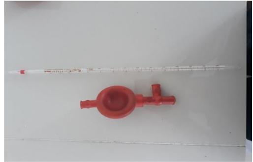
Gambar 2. Pipet dan bulb pipet
