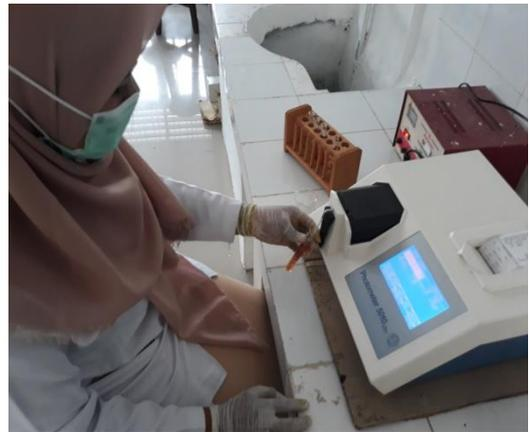
Gambar 10. Proses pembacaan Hb dengan alat Spektrofotometer
