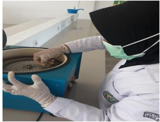
Gambar 12. Proses pembacaan dengan alat mikro hematokrit
