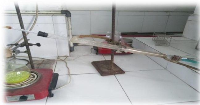
Destilasi sampel yang telah direndam dengan air panas
