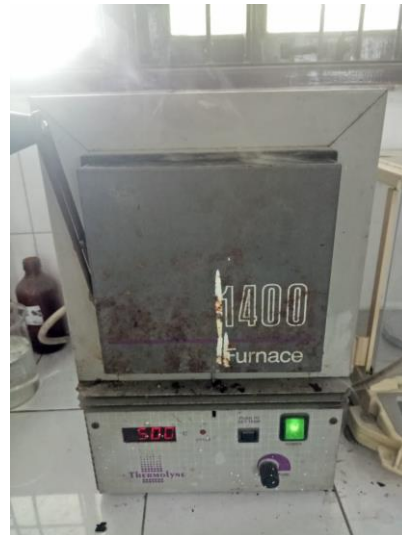
Dilakukan pengarangan didalam tanur pada suhu 500°C
