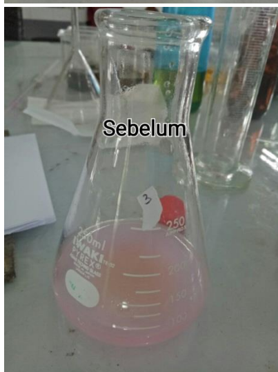
Hasil Titration Sebelum Pencampuran Dengan Karbon Aktif
