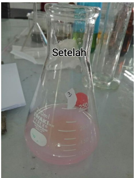
Hasil Titrasi Setelah Pencampuran Dengan Karbon Aktif Tempurung Kelapa
