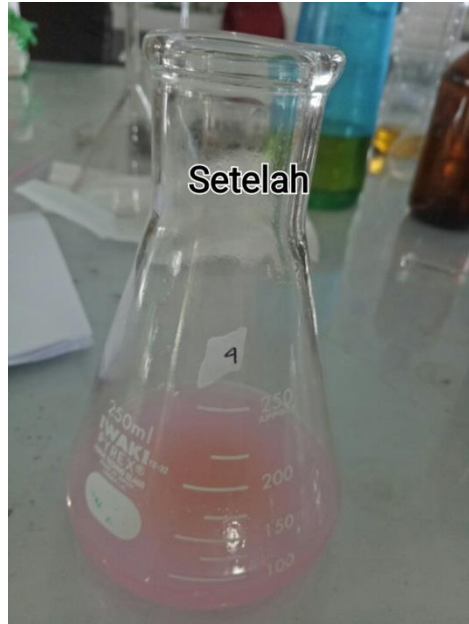
Hasil Titrasi Setelah Pencampuran Dengan Karbon Aktif Tempurung Kelapa
