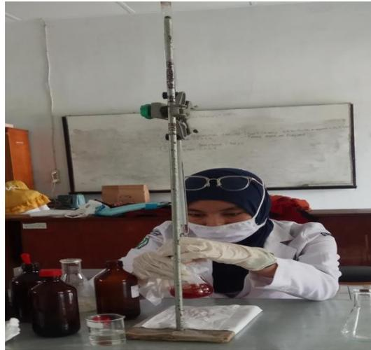
Titration dengan  $\text{Na}_2\text{S}_2\text{O}_3$  0,1 N
