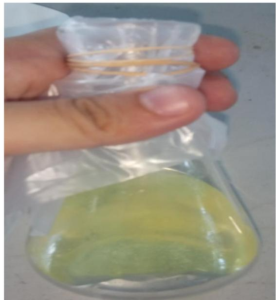
Titration dengan  $\text{Na}_2\text{S}_2\text{O}_3$  0,1 N hingga warna kuning muda
