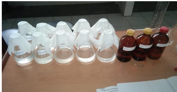
Gambar 5. Larutan dimasukkan ke dalam Erlenmeyer ditambah reagensia \text{KIO}_3 , \text{H}_3\text{PO}_4 85%, indikator Amilum dan Kristal KI
