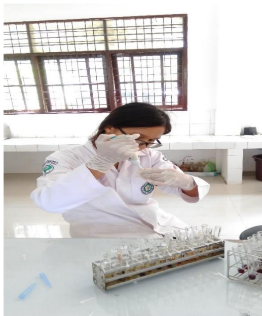
Gambar 12. Memipet serum sebanyak 10 \mu\text{L} dan menghomogenkannya dengan serum. Kemudian periksa dengan spektrofotometer.
