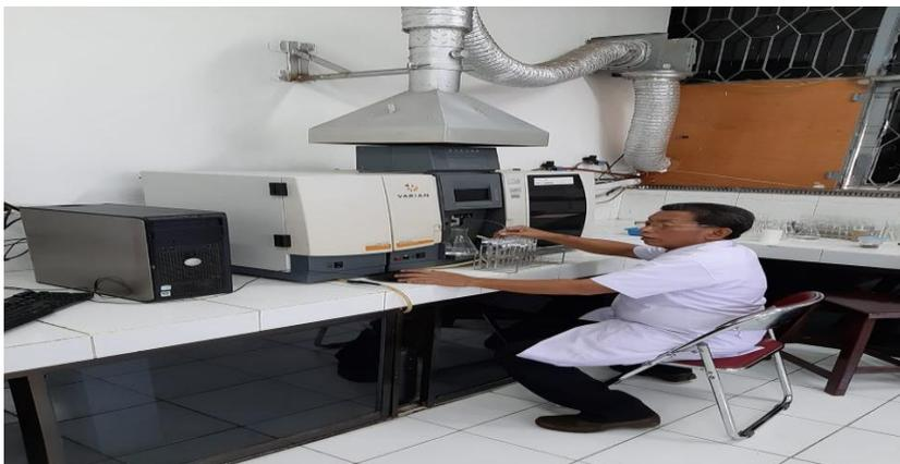
**Gambar Pengukuran Kadar Mangan Dari Sampel**
