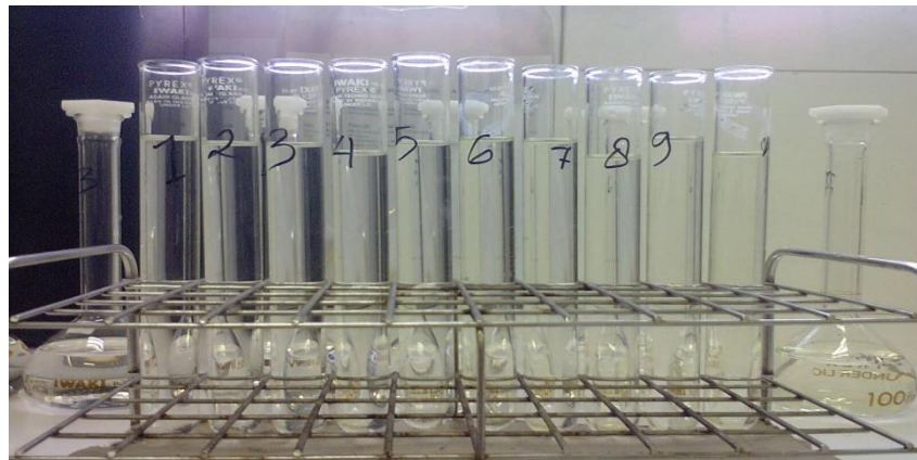
10 Sampel siap di baca dengan metode AAS (Absorbance Atomic Spectrofotometri)
