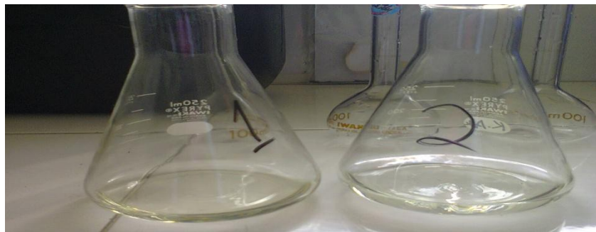
Ambil 100 ml sampel Air Sumur Bor dan Tambahkan Asam Nitrat ( \text{HNO}_3 )
