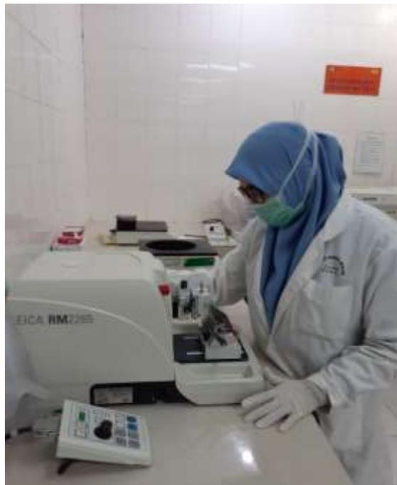
Gambar 2 pemotongan jaringan serial memakai alat microtom
