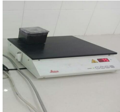
Gambar. Hot Plate Prinsip Kerja : Merubah energi listrik menjadi panas kemudian panas ini akan merambat ke lempeng yang ada sehingga menjadi panas.
