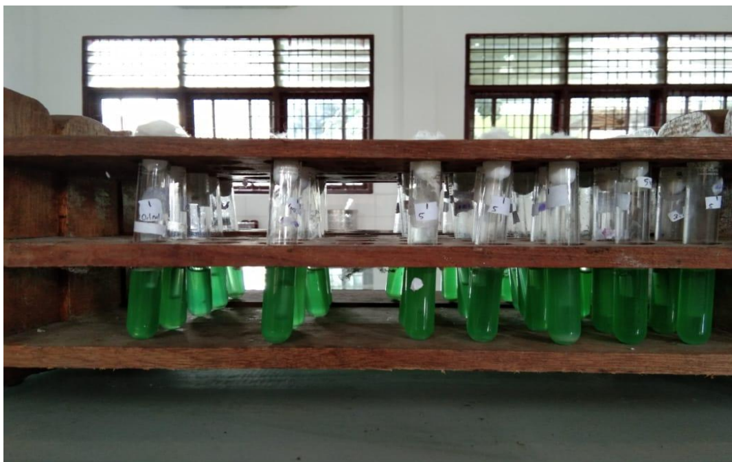
Setelah diinkubasi selama 1x 24 jam terjadi kekeruhan dan timbulnya gas pada tabung durham pada media Brilliant Green Laktosa Broth
