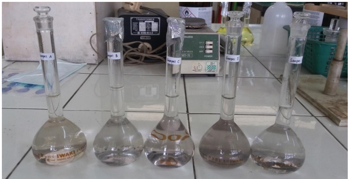
Gambar 5. Sampel telah dilarutkan dengan sedikit air panas dan \text{HNO}_3 p.a sebanyak 5 ml dan diencerkan dengan aquadest tepatkan 100 ml
