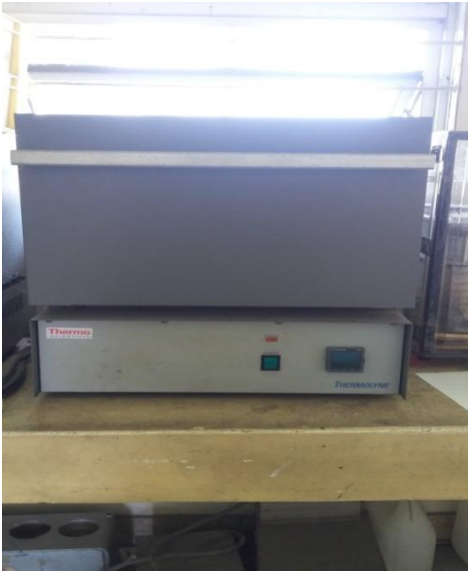
Gambar 3. Alat tanur untuk mengabukan sampel dengan suhu 550°C
