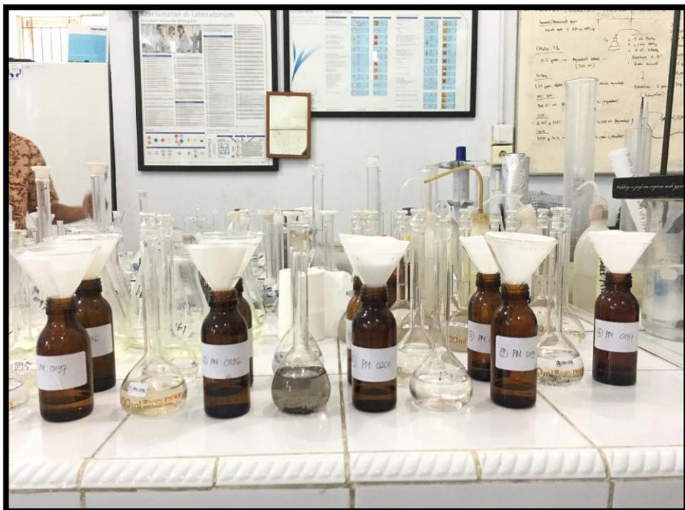
Gambar 31: Penyaringan Sampel kedalam Botol
