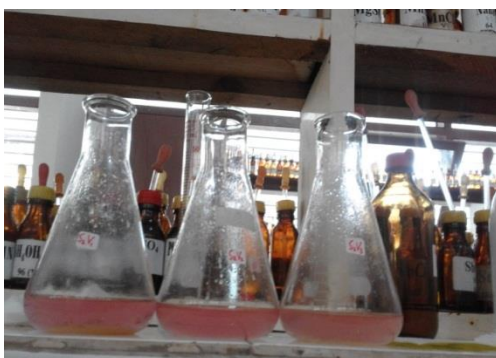
Gambar 1.13 Sampel Setelah Dititrasi Dengan Larutan Titer KOH
