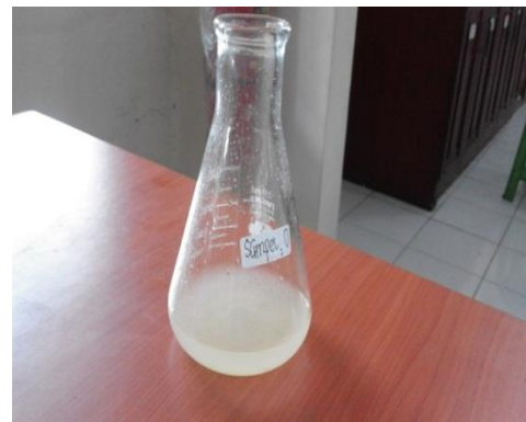
Gambar 1.12 Sampel Setelah Ditambah Etanol Netral
