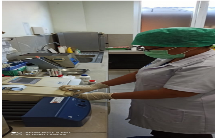
Gambar 3. Proses memasukkan sample analisa ke spektrofotometer Midray
