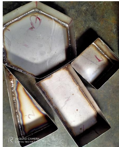
Gambar 2. Cetakan Paving block
