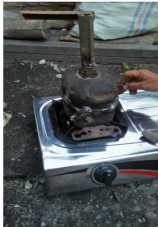
Gambar 4.3 Tabung reaktor pirolisis
