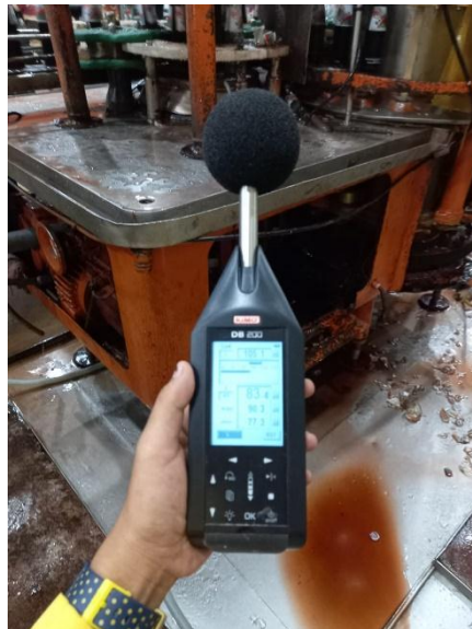
Gambar: Foto pengukuran kebisingan di area produksi Sumber: Pribadi
