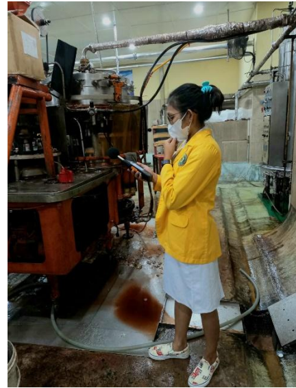
Gambar: Foto pengukuran kebisingan di area produksi Sumber: Pribadi
