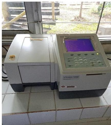
Gambar 2. 5 Spektrofotometri UV-Vis
