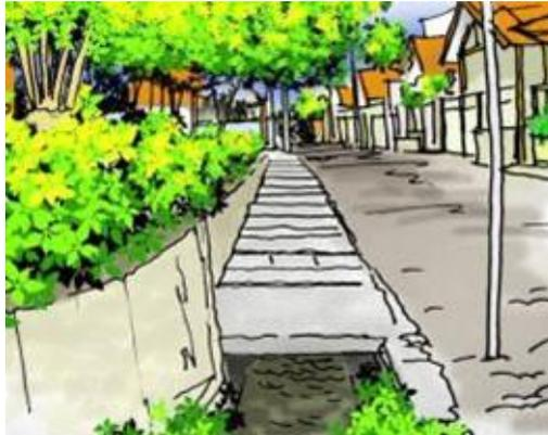
Gambar 2.3 Saluran terbuka yang ditutup plat beton (Permen PU)
