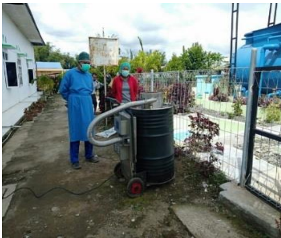
Gambar 4.5 Pemusnahan limbah padat medis dengan drum insenerator
