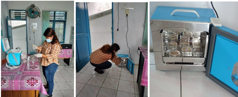
Uji kualitas air minum parameter mikrobiologi (total koliform dan e. coli) dengan menggunakan sanitarian kit
