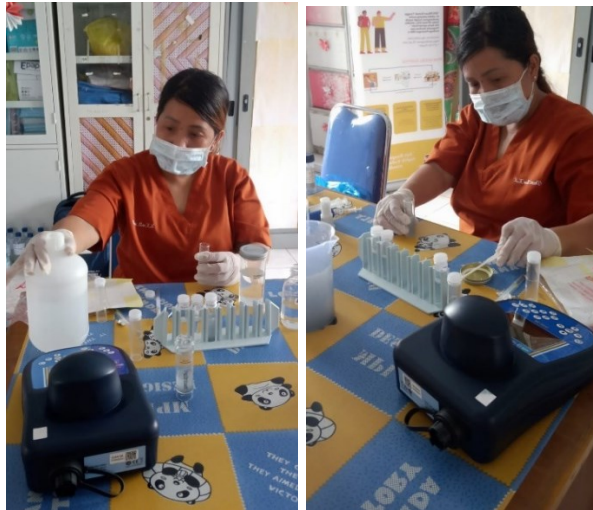
Uji kualitas air minum parameter kimia (TDS, nitrat, nitrit dan total kromium) dengan menggunakan sanitarian kit
