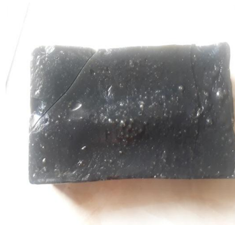
Hasil batako Styrofoam makanan
