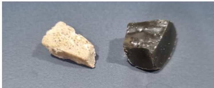
Gambar 4.1 sampel Styrofoam dengan (a) dengan campuran plastik dan tanpa campuran plastik (b) tanpa campuran
