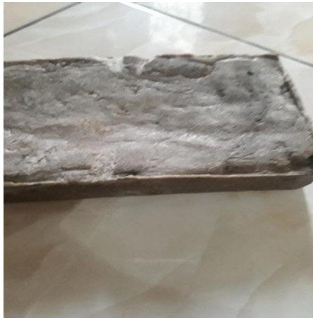
Hasil batako styrofoam campuran
