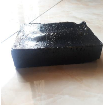
Hasil batako Styrofoam makanan
