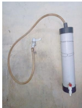
Gambar 5. Tabung filter yang sudah terpasang
