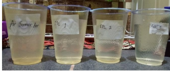
Gambar 8. Sampel air sesudah melalui saringan pasir lambat
