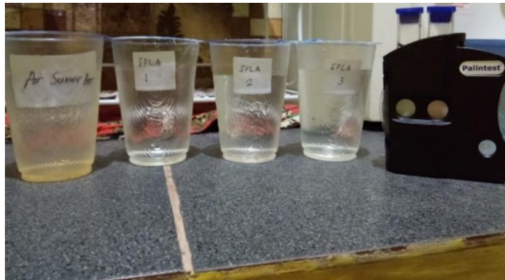
Gambar 9. Sampel air sesudah melalui saringan pasir lambat arang
