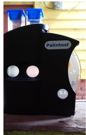
Gambar 10. Pemeriksaan sampel air menggunakan comparator kit
