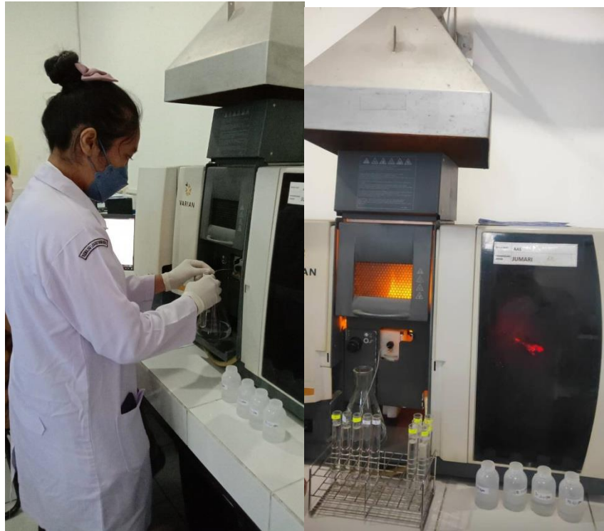
5 Sampel siap di baca dengan metode AAS ( Absorbance Atomic Spectrofotometri )
