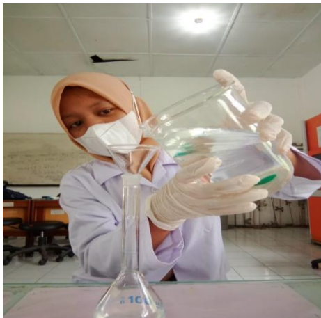
Gambar 1 : Proses preparasi sampel dimulai dari penyaringan sampel dan membuat sampel ke dalam labu ukur dan di tambahin aquades lalu dihomogenkan
