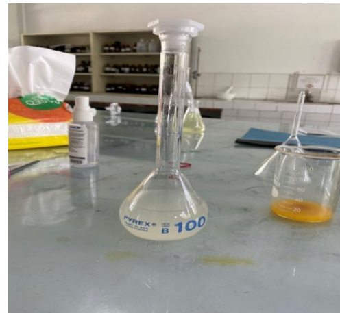
Gambar 1 : Proses preparasi sampel dimulai dari penyaringan sampel dan membuat sampel ke dalam labu ukur dan di tambahin aquades lalu dihomogenkan
