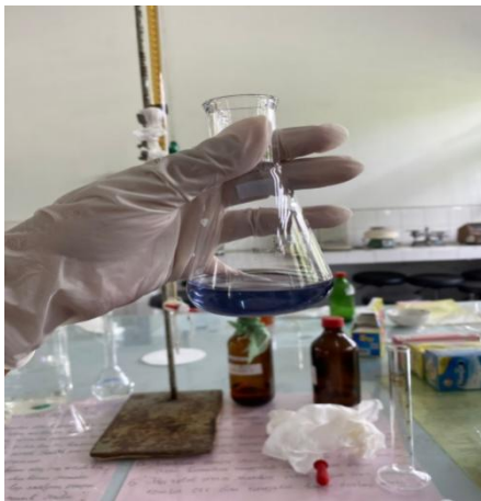
Gambar 2 : Proses melakukan titrasi iodimetri yaitu melakukan membuat reagen kedalam sampel,lalu melakukan titrasi dengan iodin hingga terbentuk warna biru.
