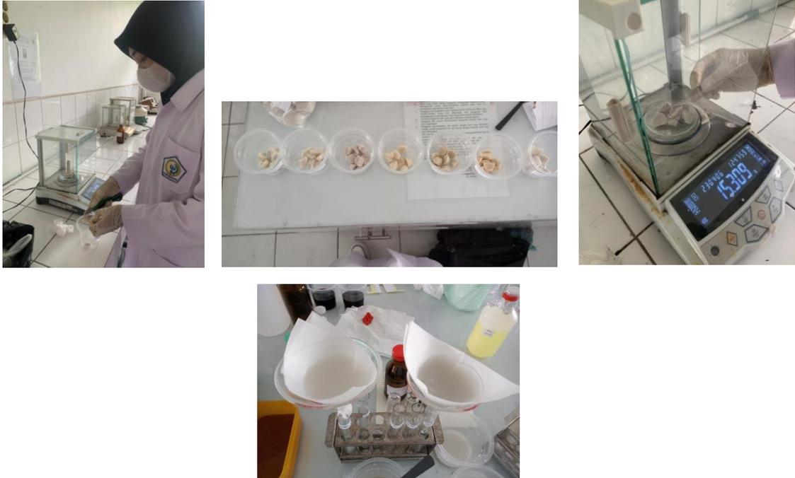
Gambar 1 : Proses preparasi sampel dimulai dari memotong bakso menjadi bagian kecil dan menimbang sampel di neraca analitik hingga penyaringan larutan sampel
