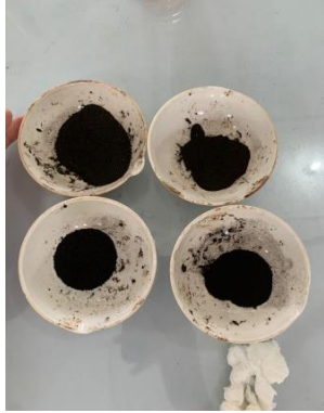
Gambar 1 : Proses preparasi sampel dimulai dari menghaluskan daun kelor dengan mortar, hingga sampel menjadi arang
