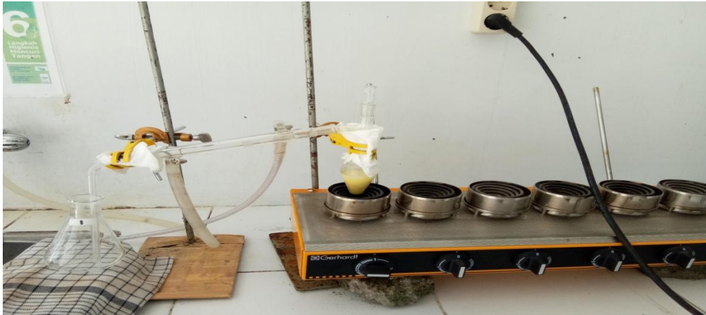
Gambar 3 Proses Destilasi Formalin Pada Mie Kuning
