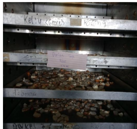
proses pengeringan cabinet dryer dengan suhu 150°C
