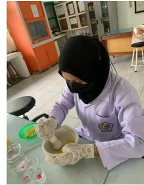
Gambar 1 : Proses preparasi sampel dimulai dari penimbangan mie di neraca analitik hingga menghaluskan dengan mortar dan alu untuk mendapatkan filtrat.
