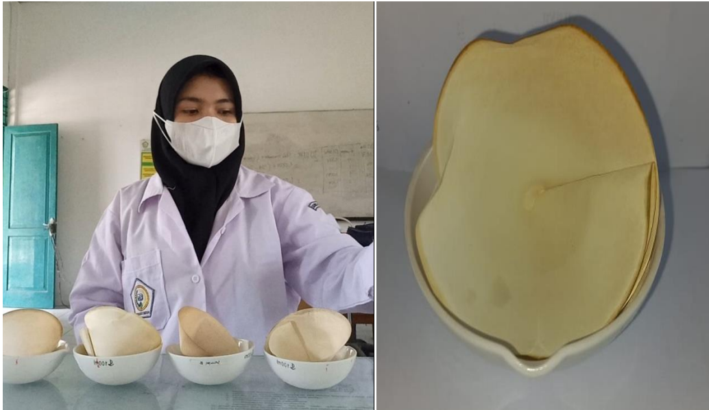
Endapan beserta kertas saring yang telah dikeringkan dalam oven.
