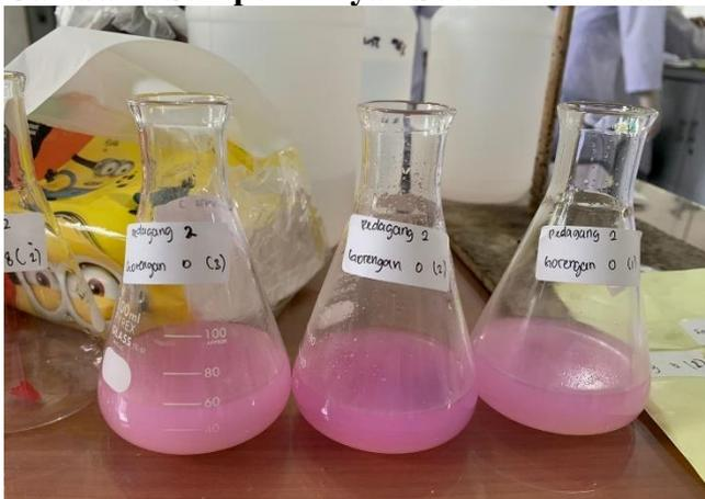
**Gambar 6 Sampel Minyak Setelah Dititrasi**
