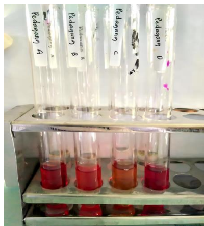
Gambar 6 : Filtrat tahu kuning sesudah ditetesi \text{KMnO}_4
