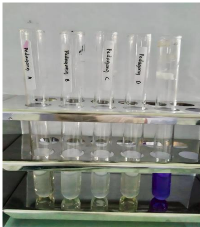
Gambar 9 : Filtrat tahu kuning sesudah ditetesi Tes Kit Formalin
